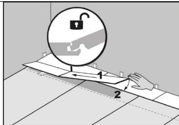
Далее следующую плитку соединяем по короткой стороне таким образом, чтобы шип по длинной стороне лёг поверх паза плитки предыдущего ряда, затем приподняв на 20 градусов обе планки сдвигайте последнюю плитку до полного защёлкивания замка по длинной стороне с плиткой предыдущего ряда. Таким же образом соединяем все последующие плитки.
